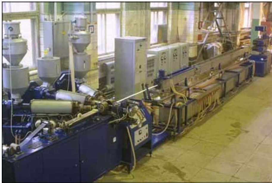
Рис.2 Линия по производству металлополимерных труб
